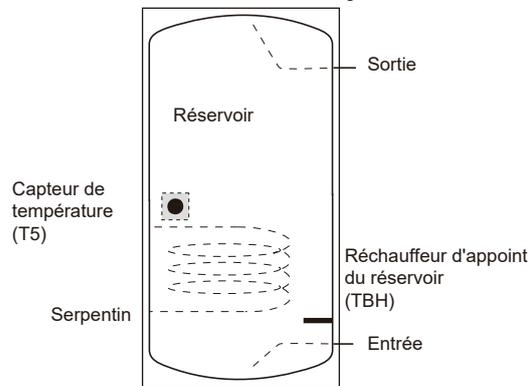
Le réchauffeur d'appoint doit être installé sous la sonde de température (T5).
