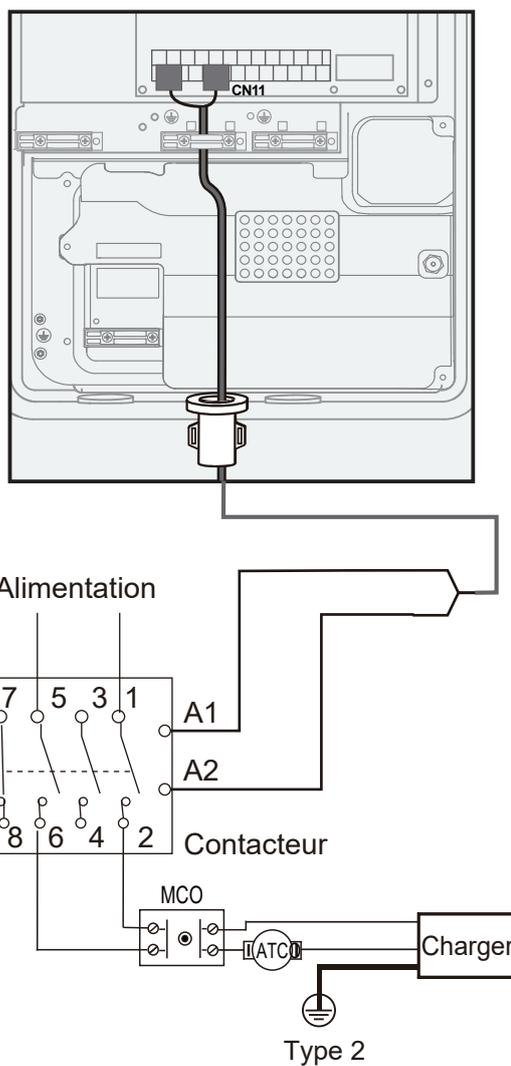
Port du signal de commande du module hydraulique : le CN1 comporte des bornes pour la vanne à 3 voies, la pompe, le chauffage d'appoint, le réchauffeur, etc.
