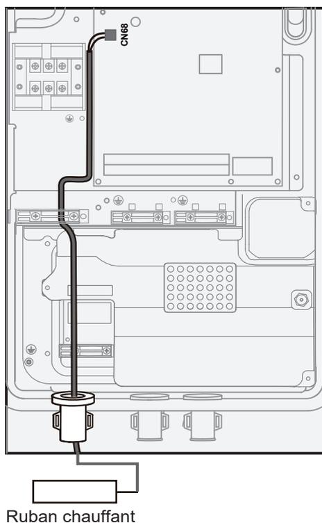
La puissance du ruban chauffant pour tuyau de drainage ne doit pas dépasser 40 W. Le courant de travail peut atteindre 200 mA, et la tension d'alimentation 230 VCA.
