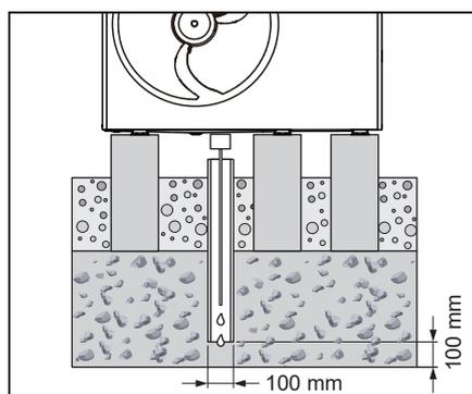
Le tuyau de descente doit déboucher sur un lit de gravier suffisamment grand pour que le condensat puisse s'écouler librement.
