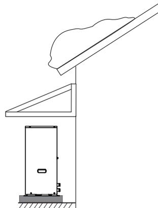
En cas de risque de glissement de neige depuis le toit, une protection ou une couverture doit être mise en place pour protéger la pompe à chaleur, les tuyaux et le câblage.
